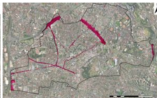
4- Zone de dépassement du seuil routier valeur "Ln" >62dB(A)
