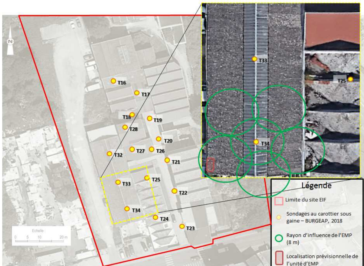
Figure 24 : Localisation prévisionnelle des installations d'extraction multiphase
