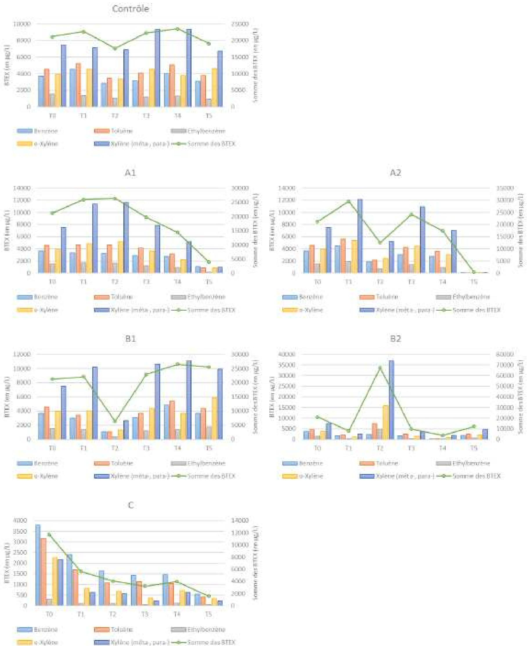
Figure 12 : Illustration de la performance de la réduction in situ pour les BTEX (extrait rapport ENOVEO en annexe 5)
