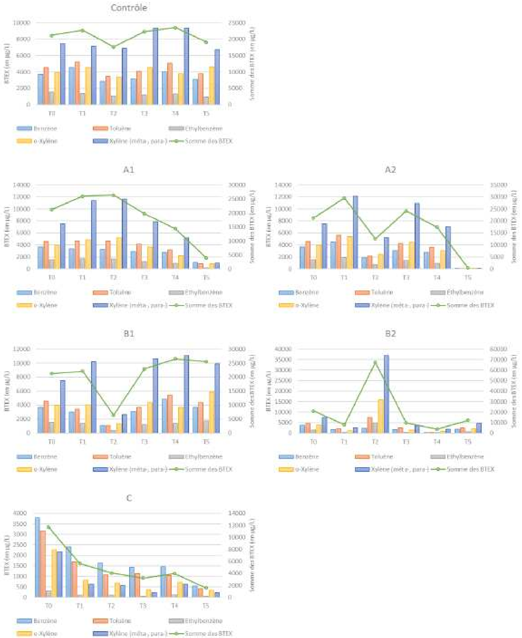
Figure 8 : Illustration de la performance de la réduction in situ pour les BTEX (extrait rapport ENOVEO en annexe 5)
